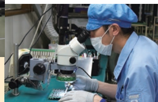
上：整理整頓された那須工場の基板実装ライン。5段階の検査工程を通じて、高品質な電子回路基板を提供している。 右：顕微鏡をのぞき、1/10ミリ精度での手はんだづけも行う。
